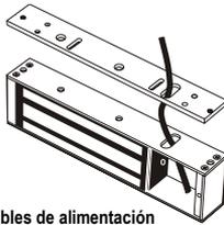
**NOTA:** El E-941SA-300 tiene cables de alimentación anexas. Omite este paso, conecte el alambre rojo a la alimentación de +12VCC y conecte el alambre negro a tierra.
